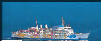
Moby ALE 93 m. di lunghezza e 16 m. di larghezza. Capacità: 800 passeggeri e 160 veicoli.
