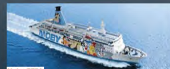
Moby DTTA 185 m. di lunghezza e 27 m. di larghezza. Capacità: 1900 passeggeri, 500 veicoli. Velocità: 27 nodi. Servizi: 400 cabine.
