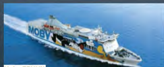
Moby TOMMY 212 m. di lunghezza e 25 m. di larghezza. Velocità: 30 nodi. Capacità: 2.200 passeggeri, 1.000 auto o 2.000 m lineari destinati al carico.
