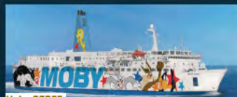
Moby CORSE 152 m. di lunghezza e 25 m. di larghezza. Capacità: 1200 passeggeri, 450 veicoli.
