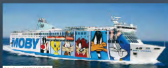
Moby WONDER 175 m. di lunghezza e 27 m. di larghezza. Capacità: 2200 passeggeri, 750 veicoli. Velocità: 29 nodi. Servizi: 320 cabine.
